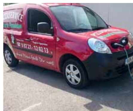
Der Renault Kangoo wird mit Strom aus dem BHKW betrieben. Mit einer Batterieladung kommt das Fahrzeug 170 km weit.
