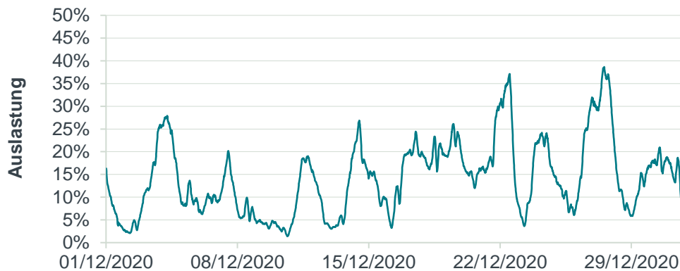
Abbildung 24 Auslastung von PV- und Windstromkapazitäten im Zeitraum 1. bis 31. Dezember 2020 (viertelstündlich)
